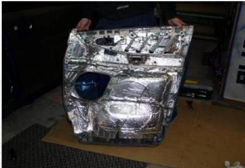
\* Плотно демпфировав внутреннюю часть двери, мы можем рассчитывать на очень хороший результат. Если говорить об эффекте звукопоглощения, то в качестве демпфирующего материала хорошо подходит мягкий бутил.
