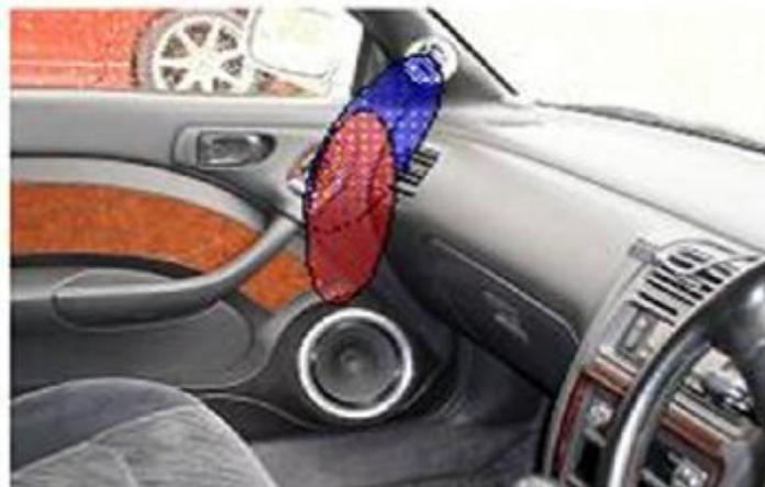
Функцией MUTE отключите звук сабвуфера. С помощью регулятора баланса или MUTE отключите один канал, оставив тот, что расположен со стороны сидения пассажира, и включите монофоническую тестовую запись. Если музыкальные образы твитера и мидвуфера будут размещаться так, как показано на рис. слева, значит оба громкоговорителя работают в нормальной фазе.
