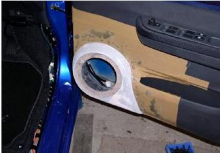
Зачистите полученную конструкцию, придавая ей нужную форму. Проверьте, нет ли трещин. Если есть замажьте их шпатлевкой и продолжите зачистку. Доведя наружный экран до желаемой формы, выровняйте его поверхность, устранивая доводочной шпатлевкой мелкие выступы и углубления. Придайте экрану окончательную форму.
