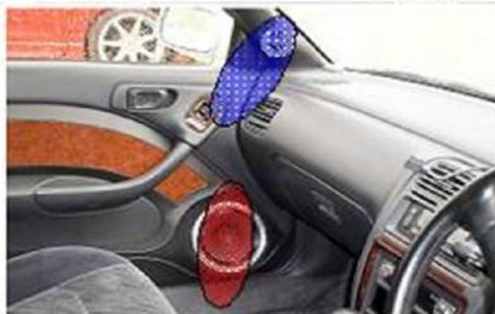
Если твитер и мидвуфер слышны порознь, как показано на рис.слева, значит два громкоговорителя работают в противофазе.
