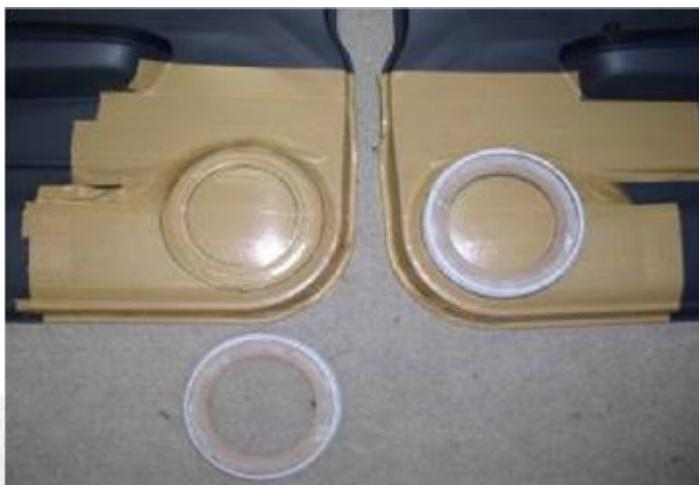
Изготовьте основную часть наружного акустического экрана, приложите ее к двери и отметьте область, которую нужно будет вырезать.
