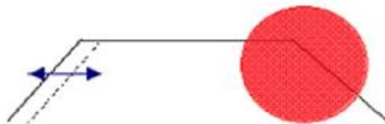
Определив крутизну спада ФВЧ и ФНЧ, перейдем к определению частоты перехода. Сначала для верхних частот. Слушая звук на частоте примерно 100 Гц (в области красного пятна на рис. слева), подбираем такую точку перехода, при которой звучание наиболее чистое и динамичное.
