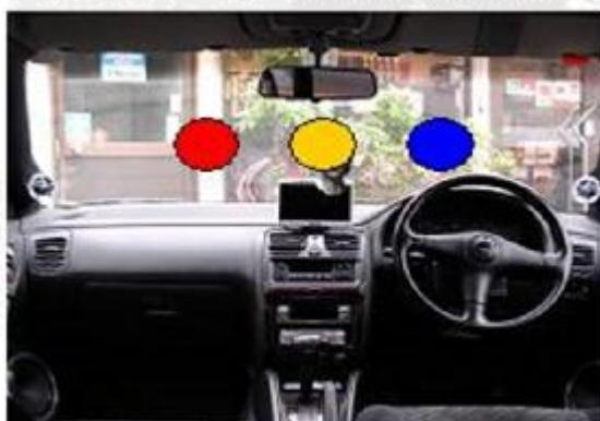
Прослушивая тестовый сигнал, отслеживайте местоположение образов на разных частотах. Если центральный образ находится посередине – там же, где и желтое пятно, определенное с помощью моно записи, значит трогать эквалайзер не надо. Если образ смещен вправо (синее пятно), опустите регулятор данной частоты справа и поднимите слева. Если центральный образ смещен влево (красное пятно), опустите регулятор слева и поднимите справа, добиваясь совмещения красного пятна с желтым.
