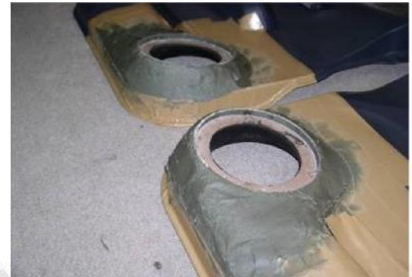
После того, как шпатлевка застынет, снимите ее с обшивки вместе с экраном.
